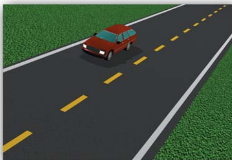
Ligne médiane discontinue
