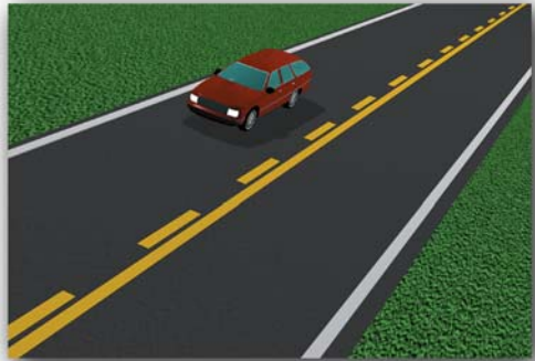
Ligne médiane discontinue avec ligne continue
